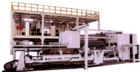
■ 高阻隔膜生产线 High Barrier Film Line
